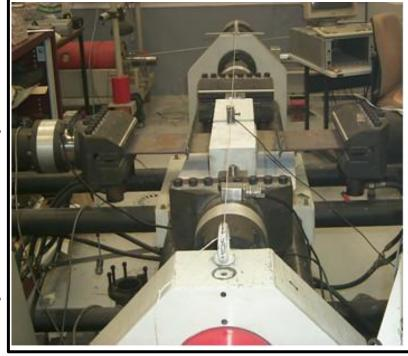
Etude du comportement d'un joint collé acier / béton lors d'un essai de traction / cisaillement
