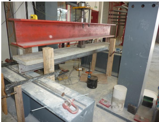
Essai de flexion 3 points sur des poutres acier / béton
