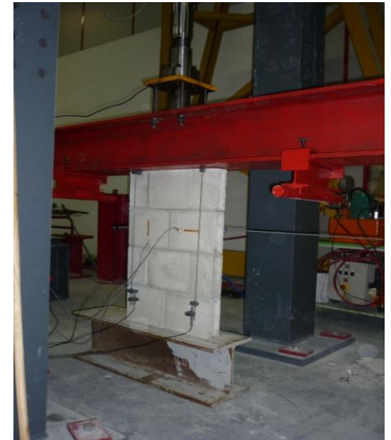
Essai de compression simple sur des murets maçonnés
