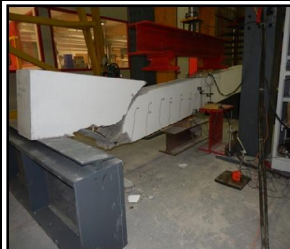
Essai de flexion 4 points sur une poutre en béton armée pourvue d' armatures alternatives en polymères renforcés de fibres
