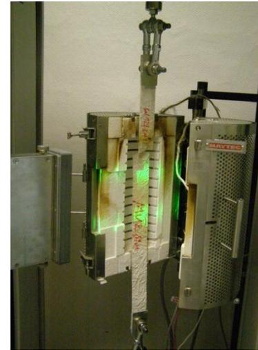
Essai de caractérisation d'éprouvettes de TRC (Textile Reinforced Concrete)
